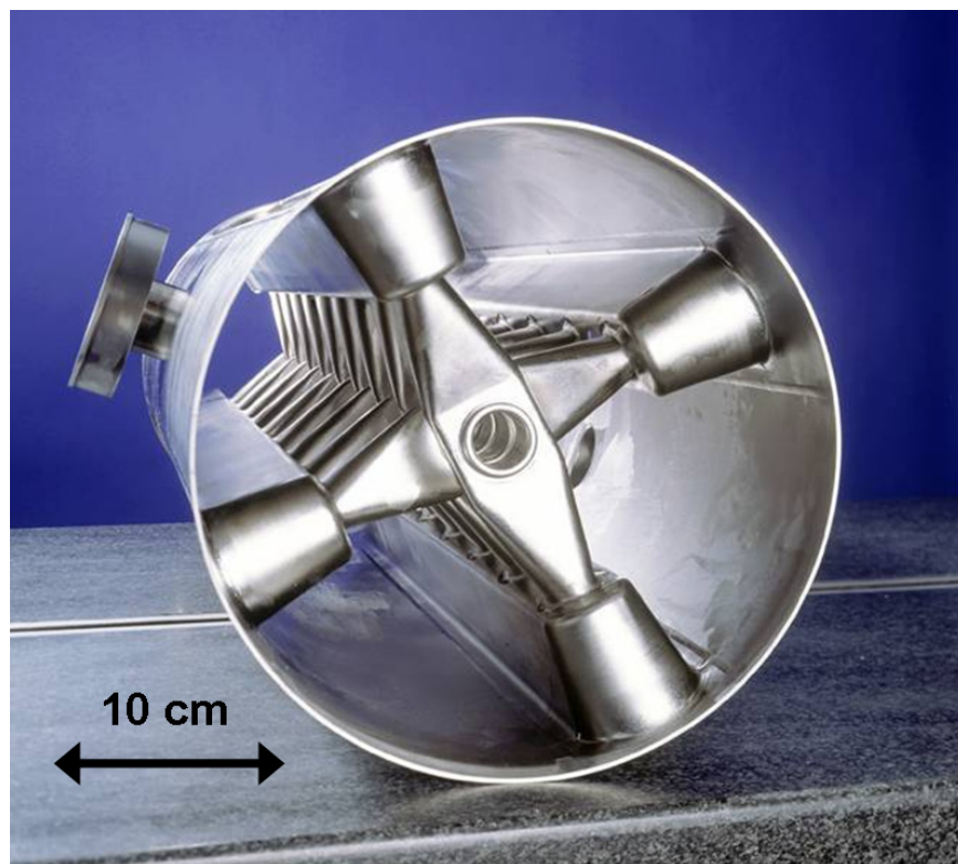
Fig. 5.13: Blick in die supraleitende CH-Prototyp-Kavität vor der Anschweißung der Endzellen.
