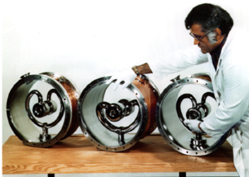
Fig. 1.1: Supraleitende Splitring Resonatoren, die für den ATLAS Beschleuniger am Argonne National Laboratory entwickelt wurden. Die Betriebsfrequenz ist 97 MHz (Eigentum Argonne National Laboratory, Argonne, IL, USA).
