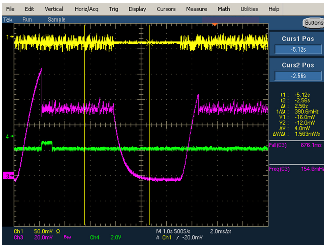
Fig. 8.7: Multipacting bei der supraleitenden CH-Struktur im gepulsten Betrieb. Oberhalb des Schwellenpegels nimmt die Feldstärke nicht weiter zu und es bildet sich ein Plateau aus. Deutlich sind die “Überschwinger” vor dem Plateau zu erkennen. Diese entstehen, weil die Elektronenlawine eine gewisse Zeit braucht, um sich auszubilden. Sie werden umso höher, je stärker die Kopplung und damit je kürzer die Anstiegszeit ist.
